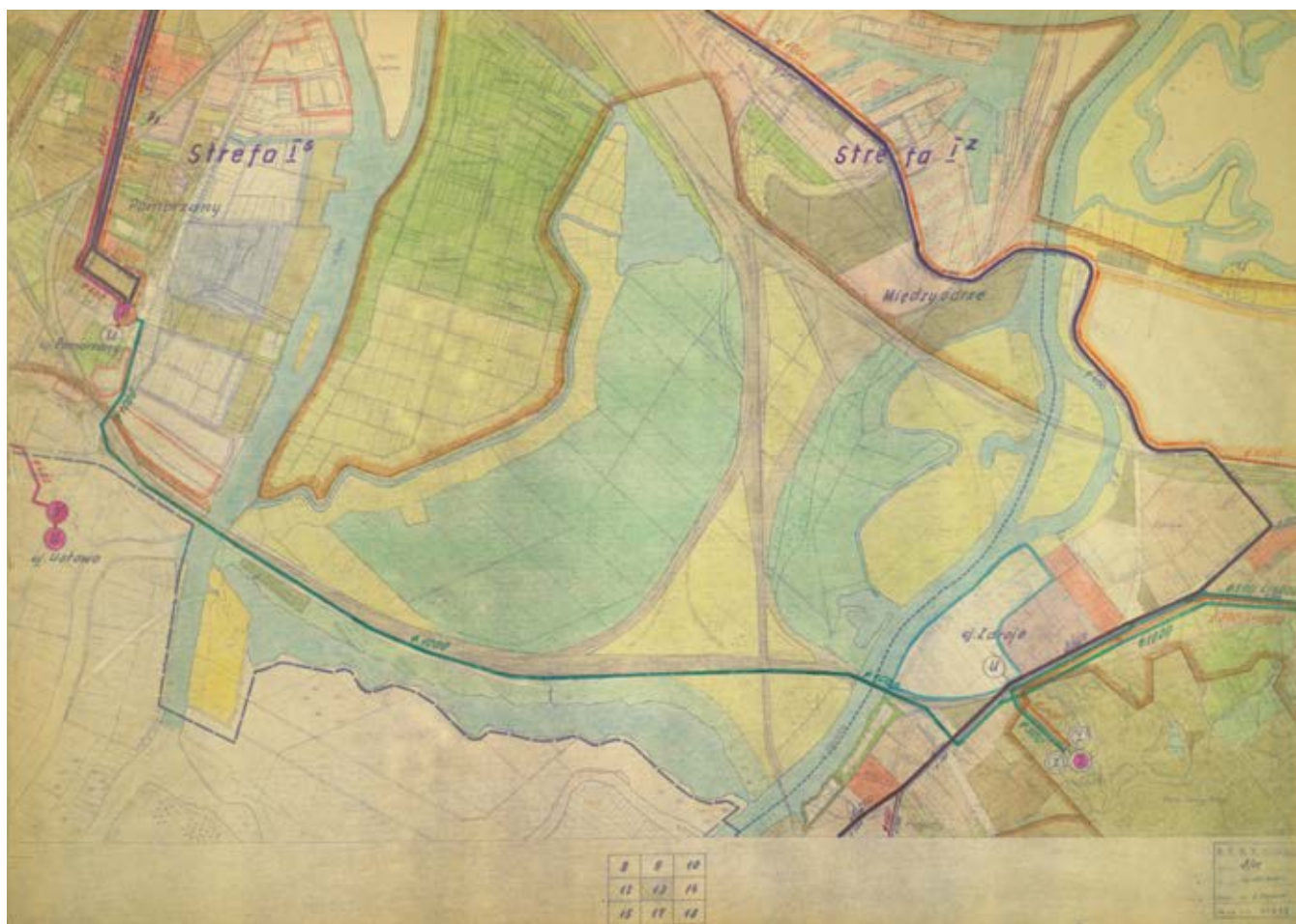
Fot. 88. Arkusz planu sieci wodociągowej Szczecina przedstawiający przebieg planowanej magistrali wodnej z Miedwia do stacji wodociągowej Pomorzany, 1964 r. (AP Szczecin, MPWiKwS, sygn. 627)
