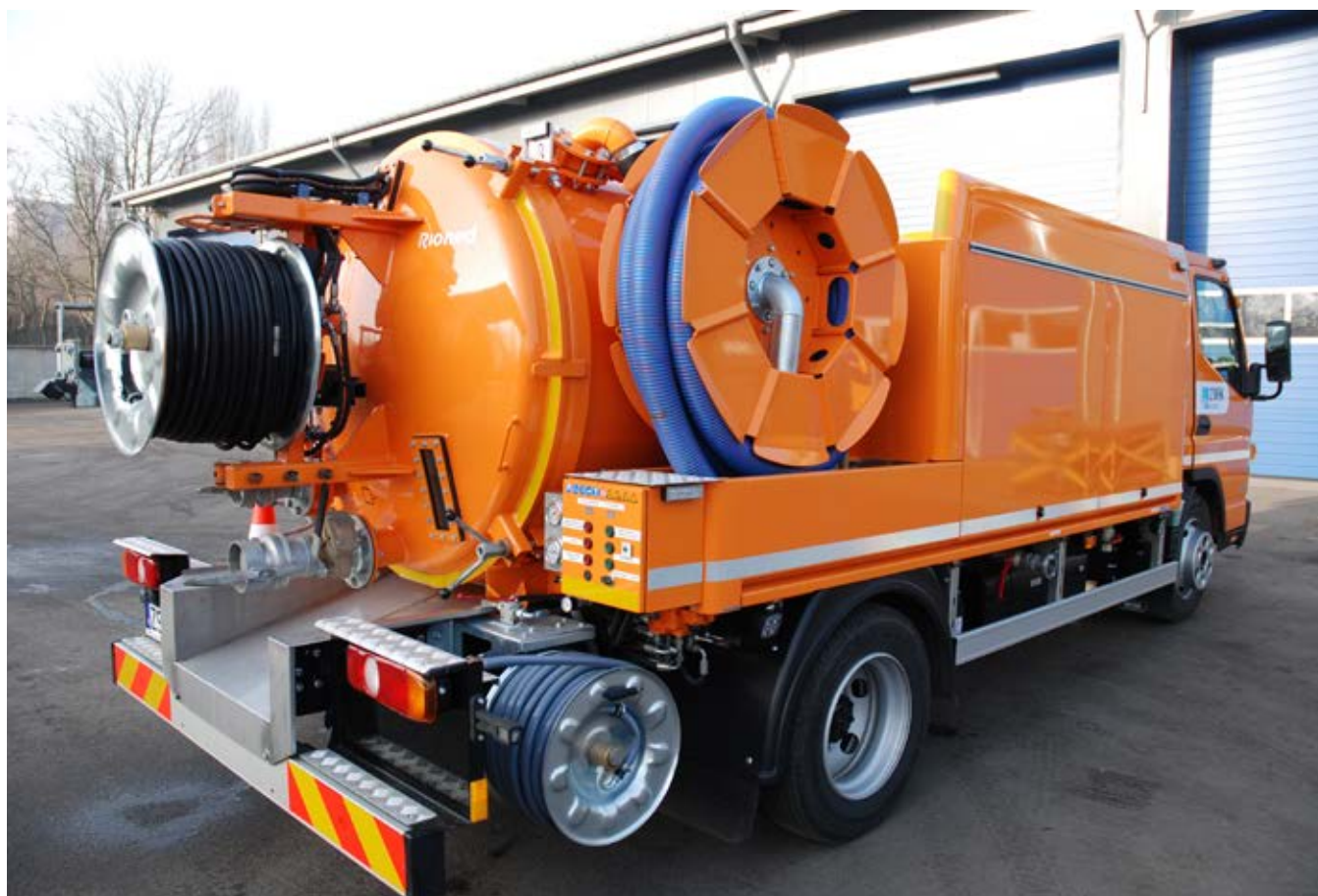
Fot. 117. Samochód do hydrodynamicznego czyszczenia sieci kanalizacyjnej
