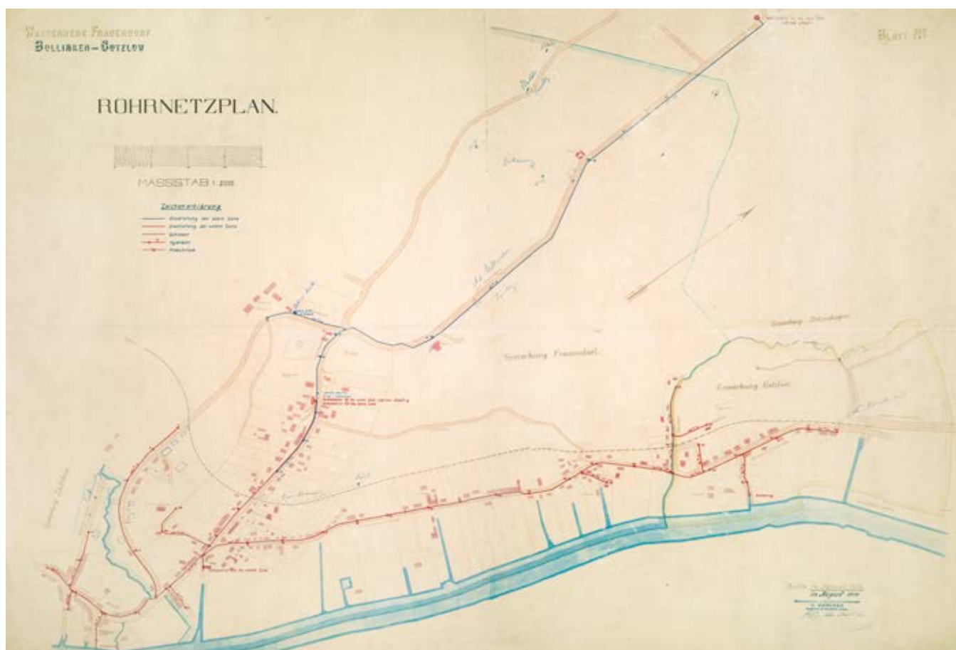
Fot. 27. Plan sieci wodociągowej w Baldynku, Golęcinie i Gocławiu, 1913–1914 r. (AP Szczecin, ZK 1826)
