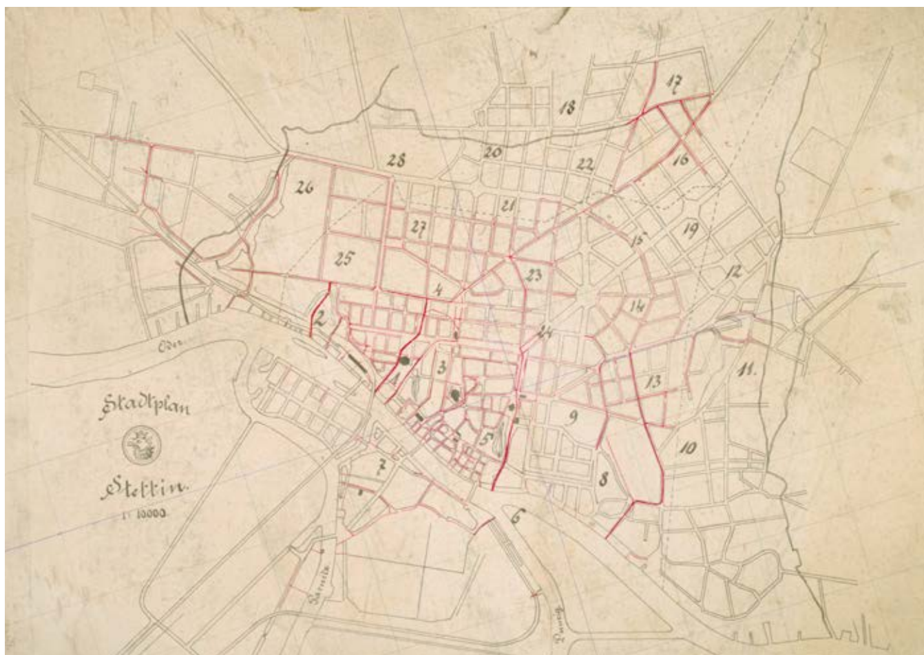
Fot. 51. Schematyczny plan kanalizacji miejskiej z atlasu kanalizacji Szczecina z 1880 r. (AP Szczecin, ZA, 23)
