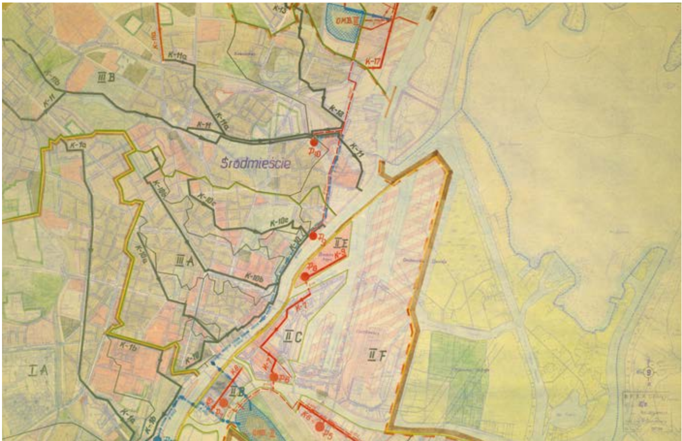
Fot. 90. Rozmieszczenie kolektorów sieci kanalizacyjnej w centrum Szczecina. Plan orientacyjny kanalizacji Szczecina. Założenia projektowe, Gdańsk 1965 r. (AP Szczecin, MPWiKwS, sygn. 629)
